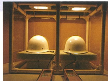
【遮熱塗装有・無による温度比較 (FRP 軽量)】
